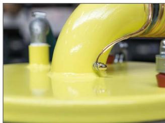
Erdung, um statische Elektrizität zu lösen
