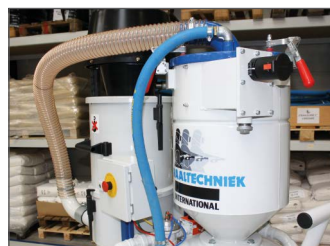
Vorabscheider mit Deckel und loseem Sieb
